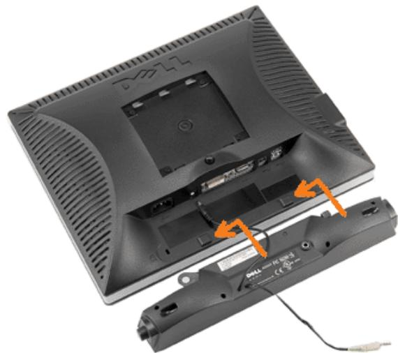
1. Working from the rear of the monitor attach sound by aligning the two slots with the two tabs along the bottom rear of the monitor. IT-IT Lavorando sul retro del monitor attaccare la Soundbar allineando i due alloggi con le due linguette lungo i lati inferiori del monitor.
